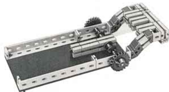
68.4 Fahrbahn mit Gegengewicht (von unten)
