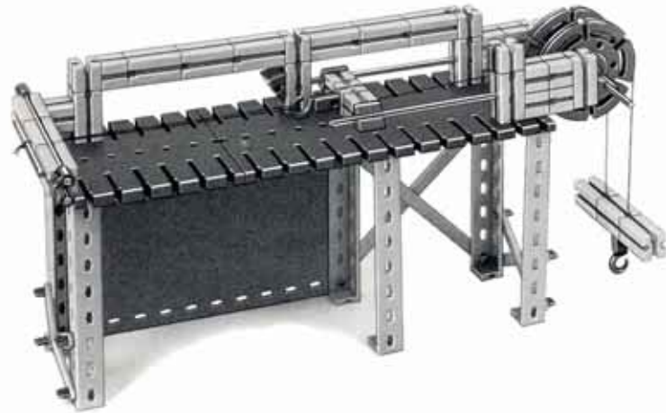
10.2 Seitenstütze zum Einhängen des Probekörpers abnehmen (im Bild: Faden)
