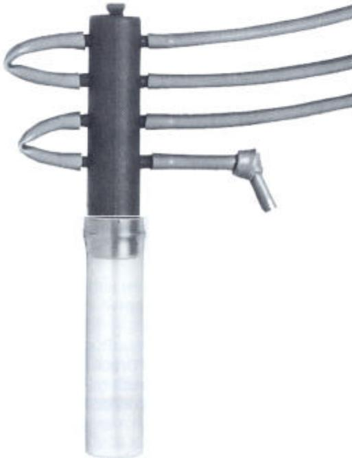
Es ist zu beachten, daß die für eine Steuerung nicht benötigten Anschlüsse verschlossen werden müssen, um zu verhindern, daß die ganze Druckluft entweicht.
