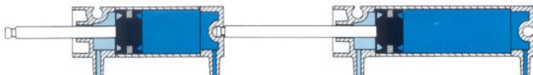
Schaltungsmäßig schließen wir beide Zylinder wie bisher doppeltwirkende Zylinder an. Die Ansteuerung nehmen wir über jeweils einzelne Rollenhebelventile vor wie bei zwei doppeltwirkenden Zylindern.
