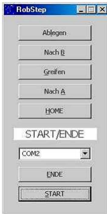
Mit der nebenstehenden Bedienoberfläche zum Betrieb des Robots in Form von einzelnen Aktionen (Teil des Projektes RobStep.SLN). Die Aktionen sind in den zum jeweiligen Button passenden Click-Routinen untergebracht. Die oberen fünf Buttons sind auf einem Panel plziert über das sie gemeinsam Enabled/Disabled werden können um eine Mehrfachbedienung zu verhindern. Hinter dem ENDE-Button steckt noch eine Parken-Routine, mit der der Robot wieder so zusammengefoldet werden kann, daß er ins Regal paßt.
