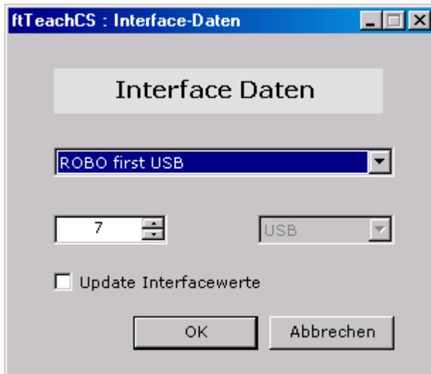
Aufruf über Menü | Extras | Interface erlaubt es die Auswahl des aktuell gewünschten Interfaces aus einer Liste der möglichen Interfaces. Bei einem Anschluß über USB kann zusätzlich noch die Seriennummer eingegeben werden. Bei Anschluß über COM kann der COM-Port ausgewählt werden.
