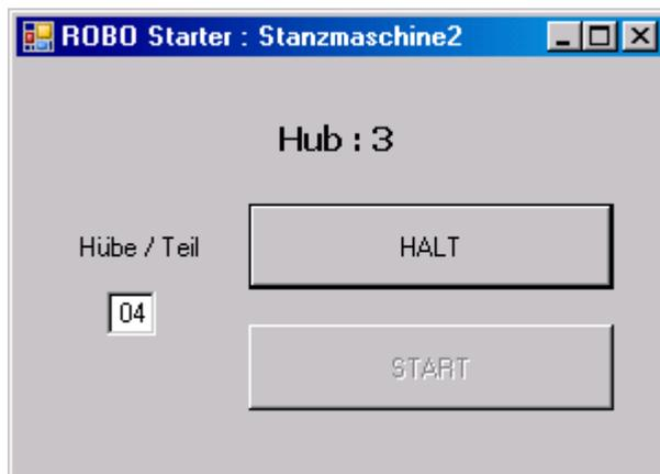
Hier wird mit variabler Anzahl Hübe / Teil gearbeitet, der aktuelle Wert wird dem Feld mskHuebe entnommen (auf einen Schieberegler wurde verzichtet, faulheitshalber). Der aktuelle Hub wird weiterhin im Feld lblStatus angezeigt.
